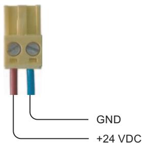
按上图所示，将接线端子与电源线连接。确保线与端子连接正确。请参考 HMI 设备背面连接针脚的标签。
