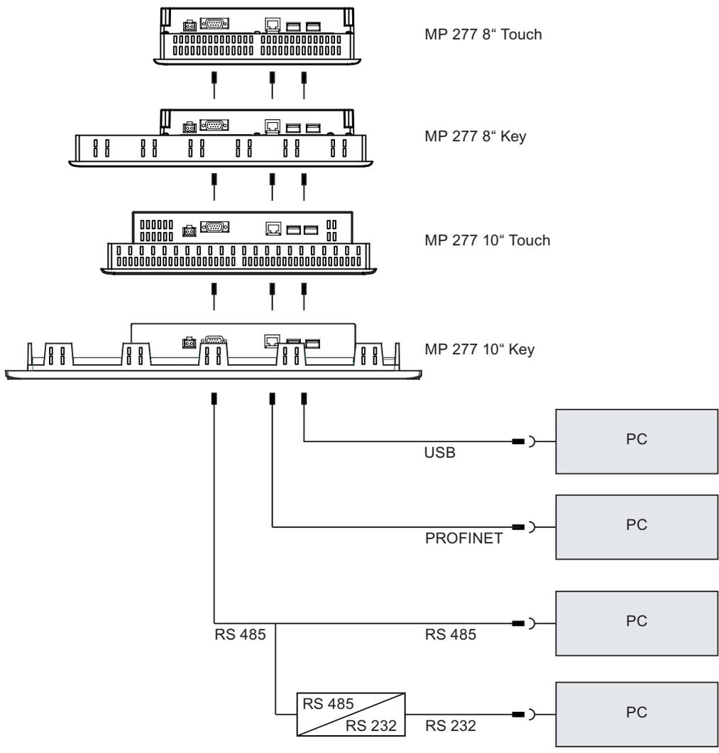
使用点对点连接时，请采用交叉线进行 PROFINET 连接。
