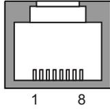
图 12-4 RJ45 连接器的引脚分配
