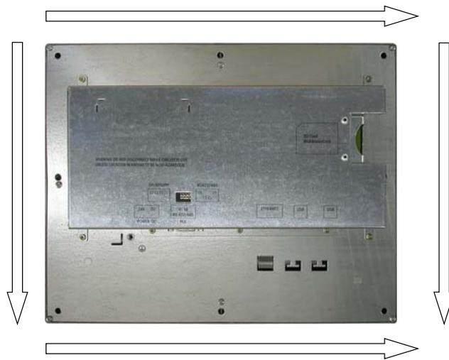
下表列出了安装卡件在 MP 277 10" Touch 上的位置。请遵守计数方向。指示的位置对应于计数方向上每个安装卡件占据的第一个凹槽。对于 MP 277 10" Touch，只能使用相隔的凹槽连接安装卡件。仅对这些可使用安装卡件的凹槽计数。插入的安装卡件将占用多个凹槽。
