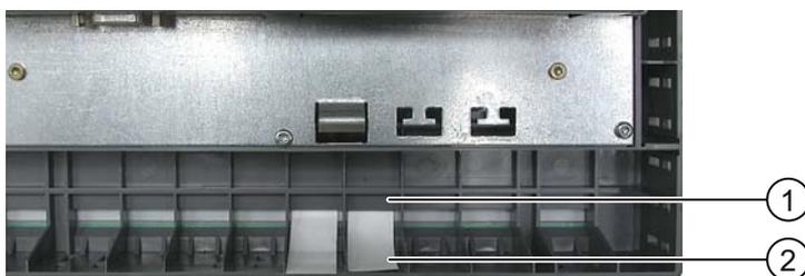
6. 将标签条滑入导轨，直到触及挡块。
