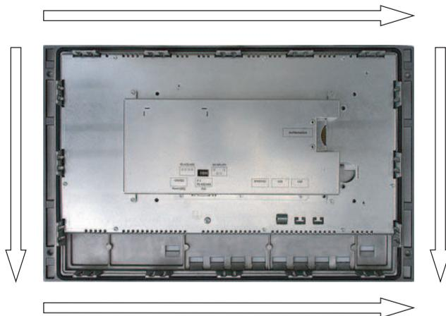
下表列出了安装卡件在 MP 277 10" Key 上的位置。请遵守计数方向。指示的位置对应于计数方向上每个安装卡件占据的第一个凹槽。插入的安装卡件将占用两个凹槽。
